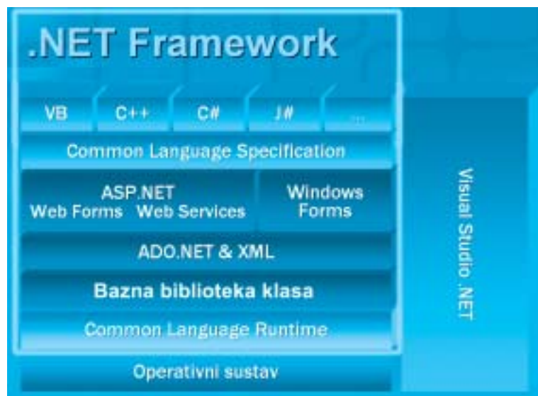
Slika 2-2: Shematski prikaz dijelova .NET Frameworka
