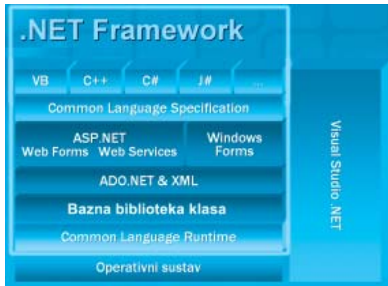
Slika 2-2: Shematski prikaz dijelova .NET Frameworka
